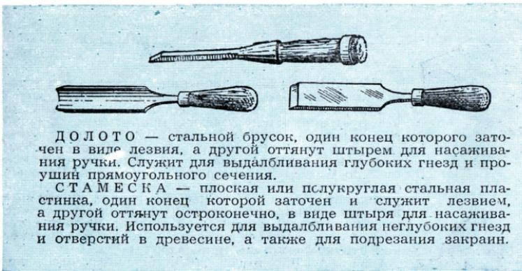
**ДОЛОТО** — стальной брусок, один конец которого заточен в виде лезвия, а другой оттянут штырем для насаживания ручки. Служит для выдалбливания глубоких гнезд и проушин прямоугольного сечения.
